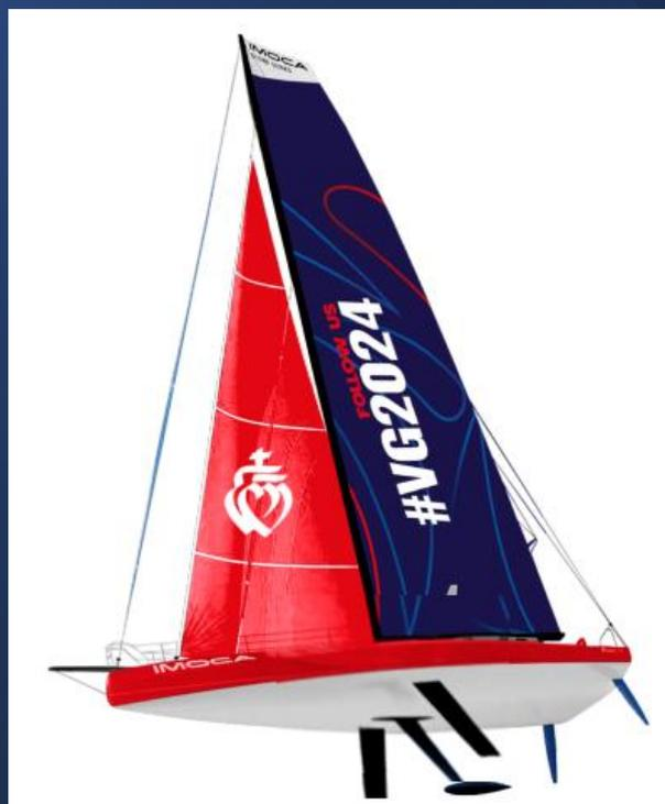
Conçus en 1986, ces monocoques sont conçus pour les allures portantes du Grand Sud... Ils n'ont cessé d'évoluer en performance grâce aux quilles basculantes, à l'informatique embarquée, aux pilotes automatiques, aux carènes et plans de voilure...
